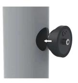
3. Insérer le BOUCHON dans le trou de manière à ce que la courbure du joint suive la courbure du tuyau principal.
